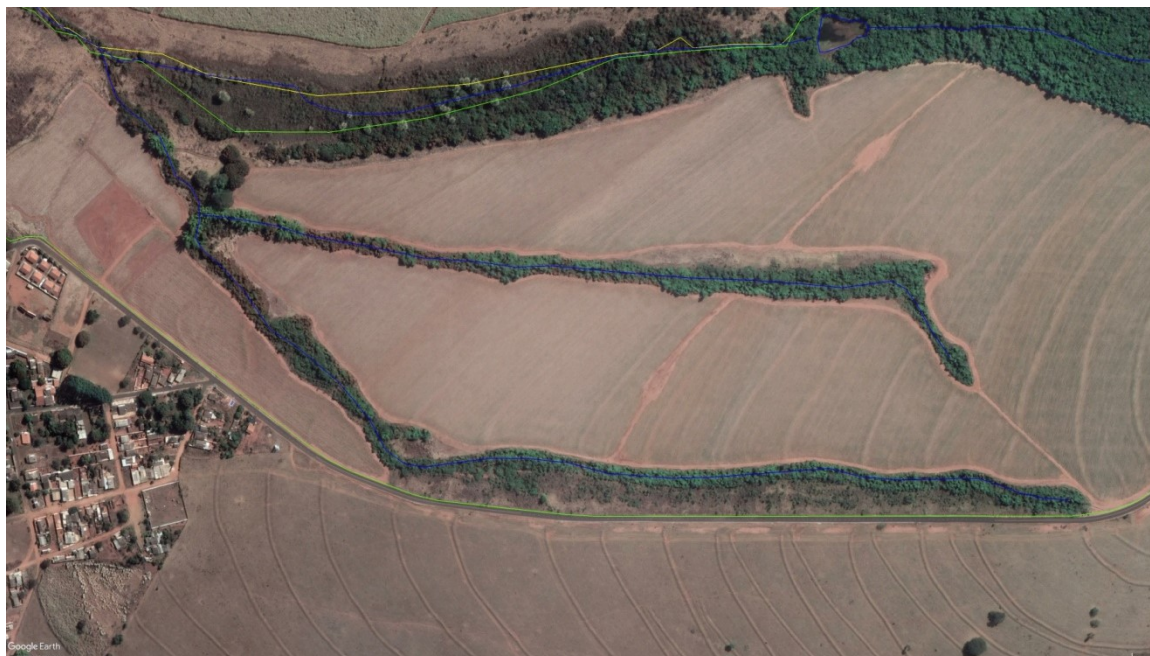
Figura 6.5.1-2 – Cicatrizes de feições erosivas lineares do tipo voçoroca, atualmente estabilizadas, localizadas na AID do empreendimento, possivelmente em área ocupada por pastagem em alguma época do passado.
