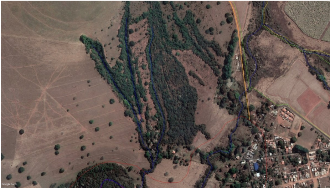
Figura 6.5.1-3 – Cicatrizes de feições erosivas lineares do tipo voçoroca, ativas no passado, visíveis na AID do empreendimento, com possível desenvolvimento em área ocupada por pastagem.
