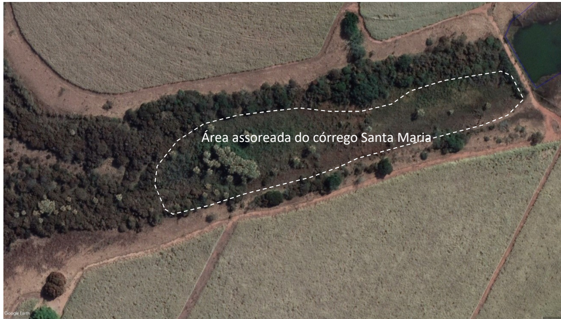
Figura 6.5.1-7 – Deposição de sedimentos em fundo de vale do córrego Santa Maria provenientes das encostas atingidas por processos erosivos.
