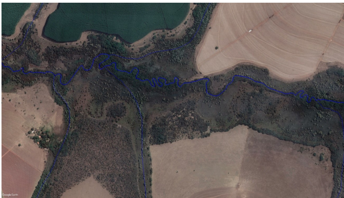
Figura 6.5.2-5 – Área úmida desenvolvida pela existência de um substrato pouco permeável em subsuperfície (basaltos) na AID do empreendimento – rio Estiva (Fonte: Google Earth).
