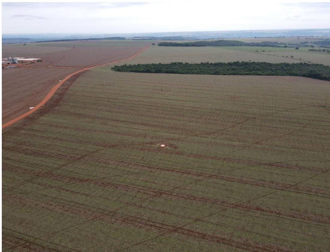
Figura 2.4 Lavoura com sistema de terraceamento/curva de nível
