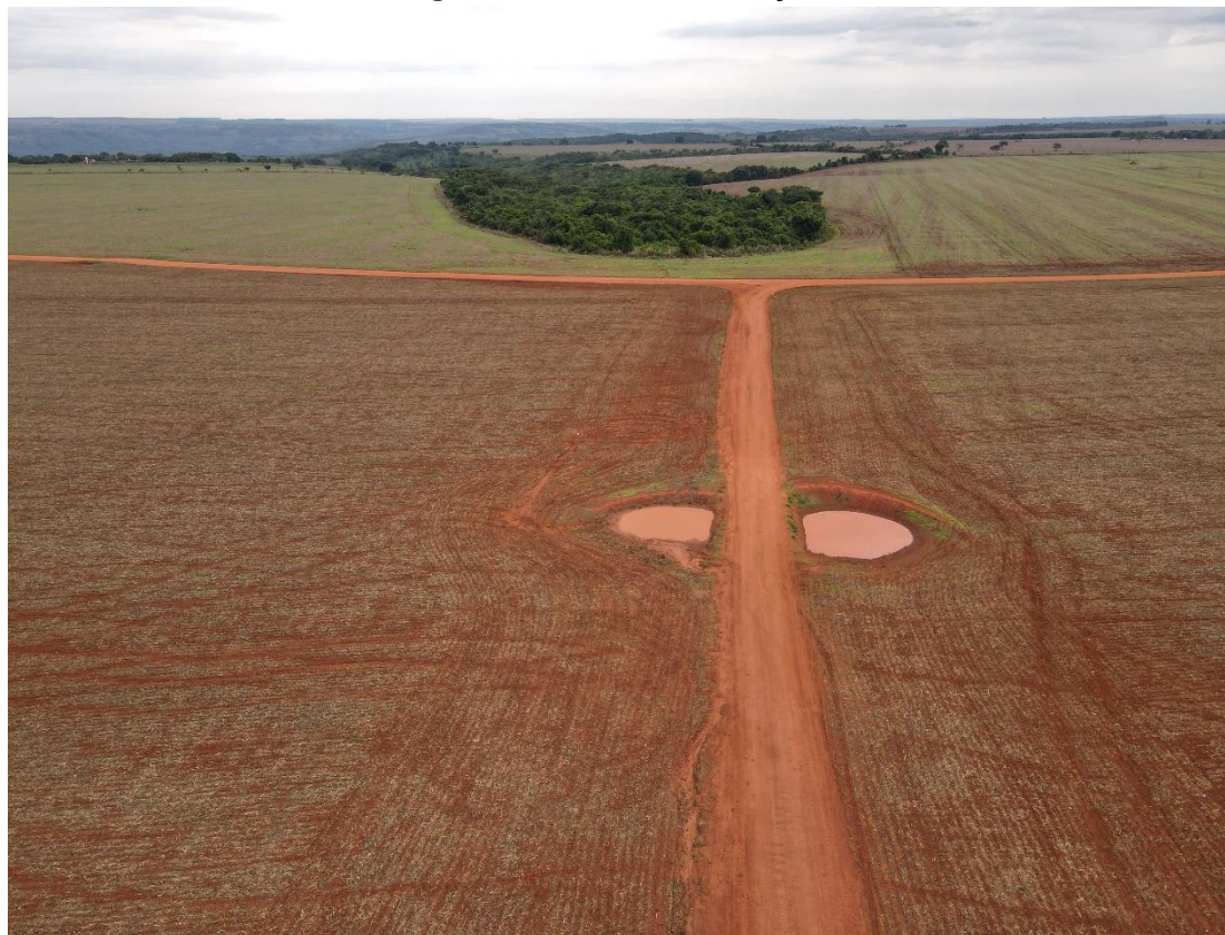
Figura 2.1 Bacia de infiltração
