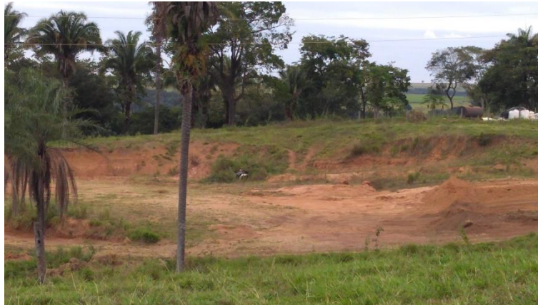
Figura 8.15 Materiais inconsolidados arenosos derivados de arenitos conglomeráticos e conglomerados da Formação Marília contendo quantidade subordinadas de seixos.
