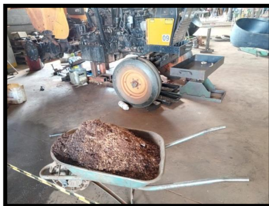
Figura 6.3. Bacia de contenção / Serragem para absorção do óleo - Oficina mecânica
