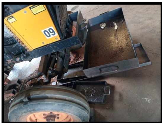
Figura 6.3. Bacia de contenção / Serragem para absorção do óleo - Oficina mecânica
