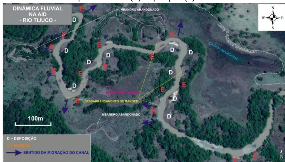
Figura 11.8. Dinâmica fluvial em trecho do rio Tijuco na área de influência direta do empreendimento. (D) Deposição: (E) Erosão.
