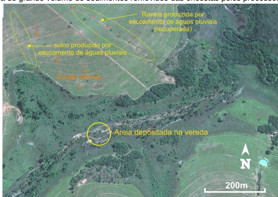
Figura 11.14. Assoreamento de canal fluvial de um dos afluentes do rio Cabaçal em razão da incidência de grande volume de sedimentos removidos das encostas pelos processos erosivos.
