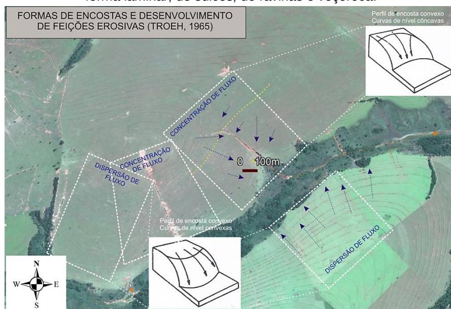
Figura 11.13. Feições erosivas em encostas identificadas na AID do empreendimento sob a forma laminar, de sulcos, de ravinas e voçoroca.
