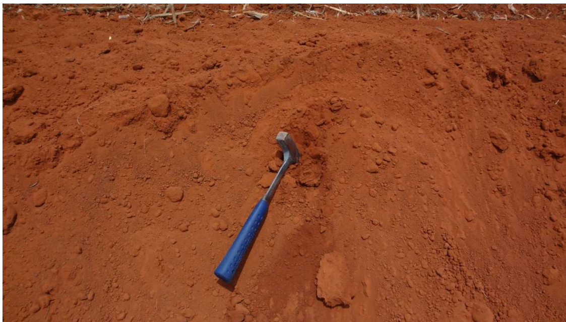
Figura 4.4.3-4: Detalhe da cobertura cenozóica com maior teor de areia.
