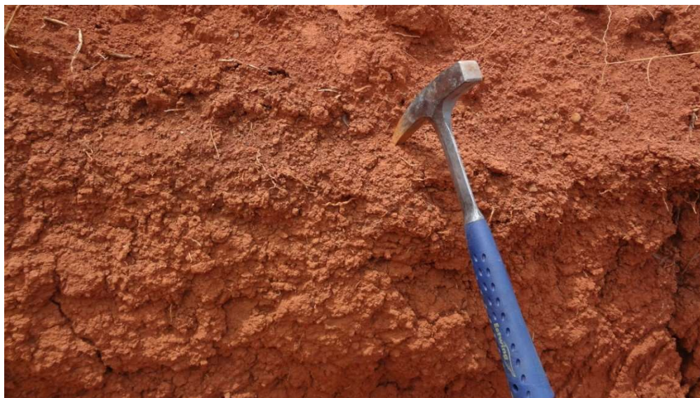
Figura 13.7.3.1.1-1: Material inconsolidado transportado argilo-arenoso presente na ADA do empreendimento. Atentar para a ocorrência de grumos estáveis de argila e nódulos ferruginosos.
