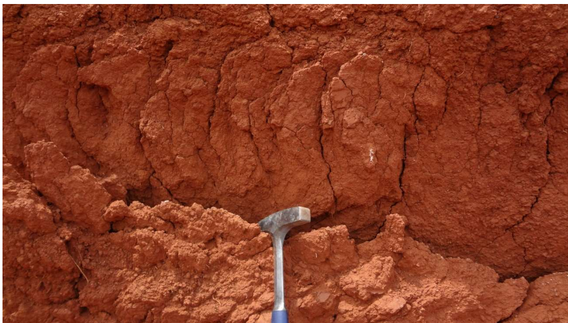
Figura 13.4.4.3-2: Aspecto dos materiais detrítico-lateríticos da cobertura cenozóica. Texturalmente, se caracterizam pela predominância de argila.
